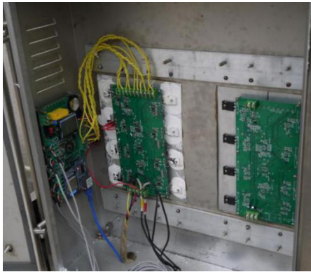
附图 1 光伏组件户外特性测试平台内部电路
