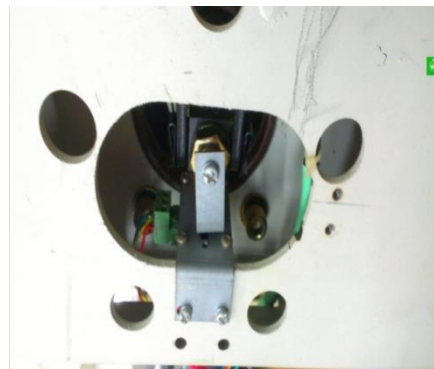
图 2 直线位移传感器安装方式
