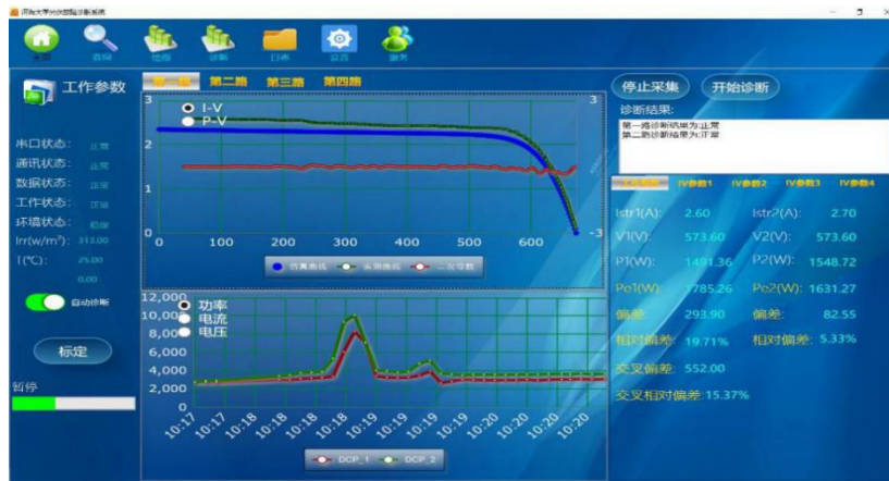
附图 1 正常情况下光伏阵列故障状态智能诊断系统界面
