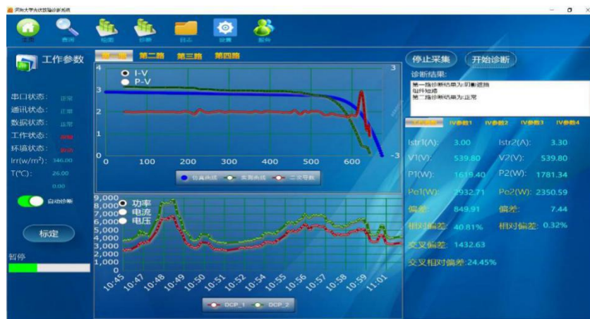
附图 2 正常情况下光伏阵列故障状态智能诊断系统界面
