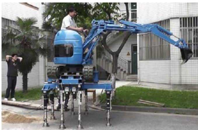
针对抗洪抢险环境的特殊性和打桩的要求，本项目“高速智能堤坝抢险打桩平台关键技术的研究”在水利部水利部公益性行业科研专项项目经费的资助下，河海大学课题组成员将机械、自动化、液压控制等多学科的先进技术和水利事业的发展需要相结合，开展了对智能堤坝抢险打桩平台一系列关键技术的研究。
