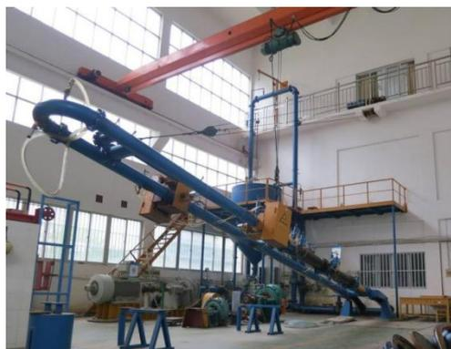
系统等组成。高精度电磁流量计、差压传感器、放射线密度计等测量仪器设备，全部采用进口，确保了整个实验台的测试精度。实验台已获发明专利授权1项，发明专利受理3项，实用新型专利授权2项。
