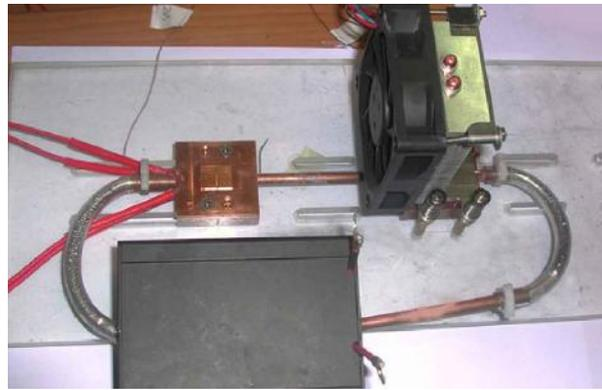
图 3 散热方案及测试样机
