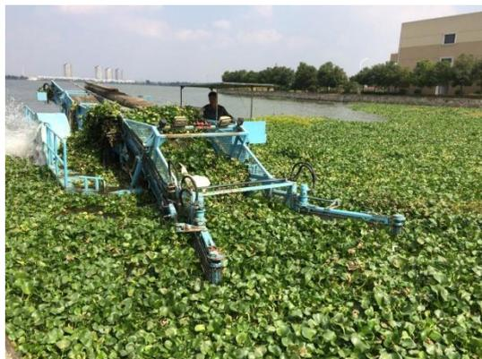
城乡河网漂浮物高效清理设备所配备的大角度高效收集臂、分散漂浮物收集耙、可调节压缩机构、可调节立体切割装置、边坡浅滩双层收集臂、耐磨剪切刀具等新型高效的收集、切割机具和装置，极大地提高了水生植物和漂浮物的切割打捞收集效率。“河湖清漂 001 号、002 号、003 号”已在昆山市巴城镇阳澄湖水域进行了多年的示范应用，各项性能指标和机具功能在漂浮物和水生植物的清理过程中，得到了全方位、长时间、高强度的测试和考验。三台清漂设备年均打捞水生植物可以达到 11200 余吨，保洁水域面积达 28.56 平方公里，有效遏制了水葫芦或其它水草大面积繁殖的现象，保证了巴城镇河网水系的水面清洁，为昆山市巴城湖省级水利风景区的建设做出了重要贡献。项目成果的应用取得了显著的社会效益、生态效益和经济效益。设备样机“河湖清漂 001 号、002 号、003 号”在示范基地的现场工作情况如下图所示。
