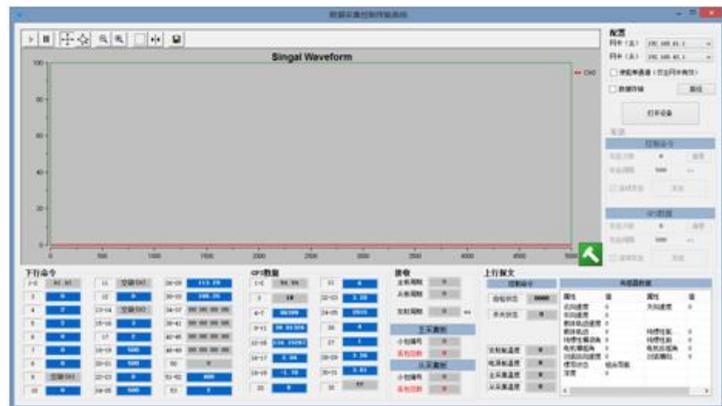
(6) 通过串口接收信号采集板转发的显控台控制命令，进行命令解析和分包，再通过各串口分别发送各种对应的控制命令和设置参数给控制电机和各个传感器。
