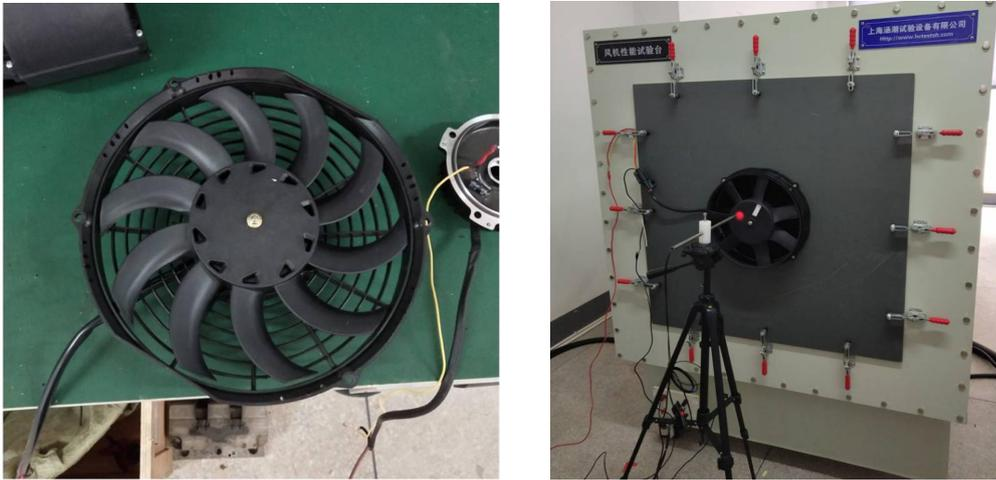
图 3 车辆用无刷直流风机叶轮样机及测试
