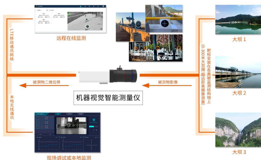
图 3 机器视觉智能测量仪监测水库大坝位移测量模式
