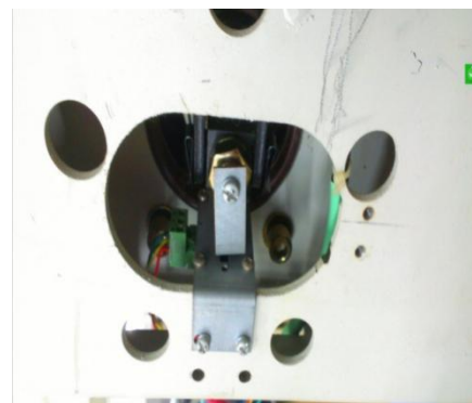
图 2 直线位移传感器安装方式
